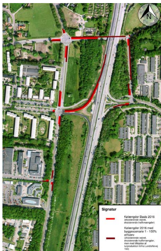
Figur 7 Maksimale kølængder i morgenspidstimen i Forslag 3 100% erhverv
